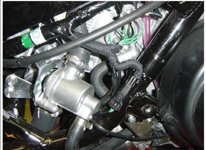
Tagliare il filo **rosa** lungo il suo percorso per inserire in serie (con saldatura a stagno) un diodo 1N4001, assicurandosi che il catodo del diodo (contrassegnato da una lineetta) sia rivolto verso il freno di stazionamento.
