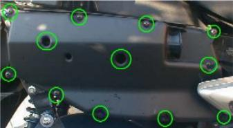
Al rimontaggio controllare attentamente che le guide s'inseriscano correttamente nelle sedi.
