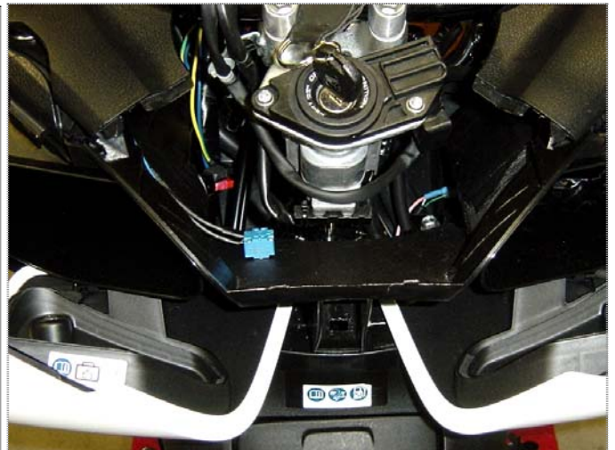
Potenziometro di regolazione volume montato tra i due cassette portaguanti
