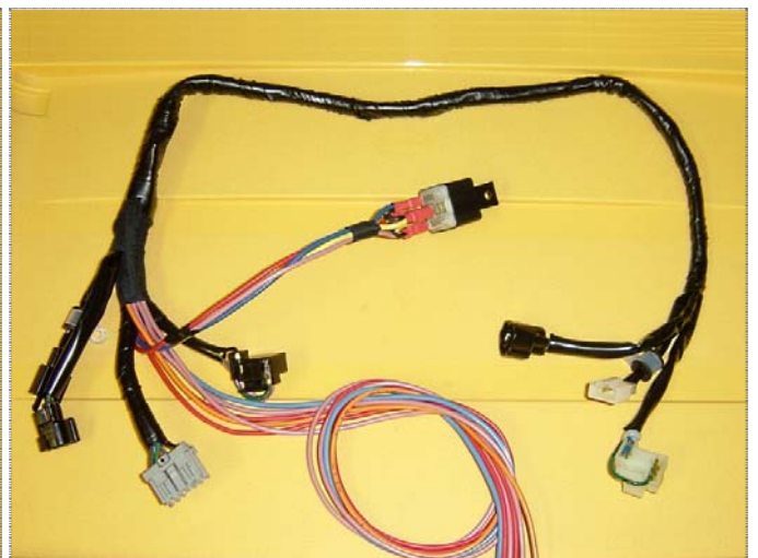
Cablaggio del musetto modificato.
