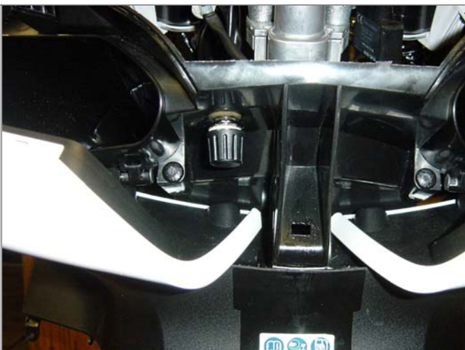
Potenziometro di regolazione volume montato tra i due cassette portaguanti
